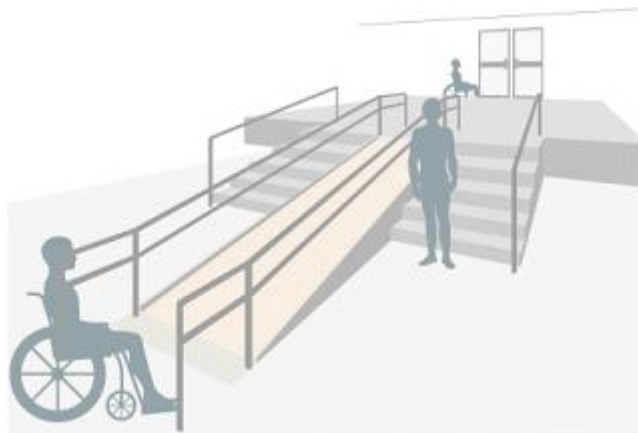
Figura 4: Exemplo de eliminação de barreira arquitetônica.
